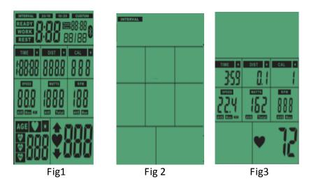
INTERVAL10/20、 READY、 WORK、 REST、 TARGET、 TIME、 DISTANCE、 CALORIES、 TIME、 DISTANCE、 CALORIES、 WATTS、 SPEED、 RPM、 HEART RATE flicker for 1 second in sequence in SCAN mode (similar to Figure 2).
